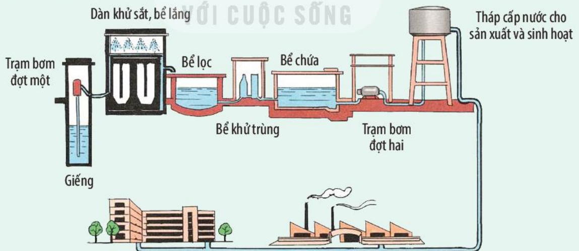
Hình 8. Sơ đồ dây chuyền sản xuất và cấp nước máy
