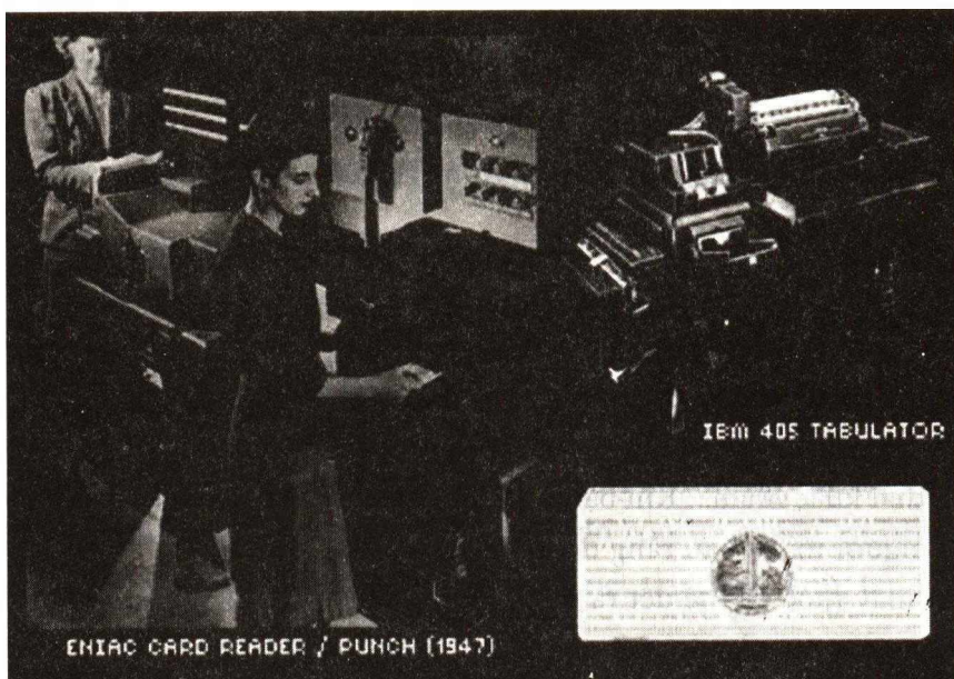
Bên trái: một nữ vận hành máy tính đang cho các tấm bia đục lỗ vào máy ENIAC (1947). Bên phải: Bộ lập bảng IBM 405 giúp người vận hành tính kết quả của đầu ra.
