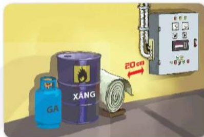
b) Chất đốt để gần tủ điện
