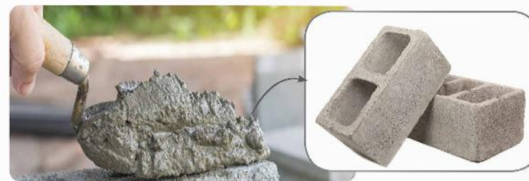
e) Hỗn hợp xi măng, cát và nước đồng cứng sau khi trộn
