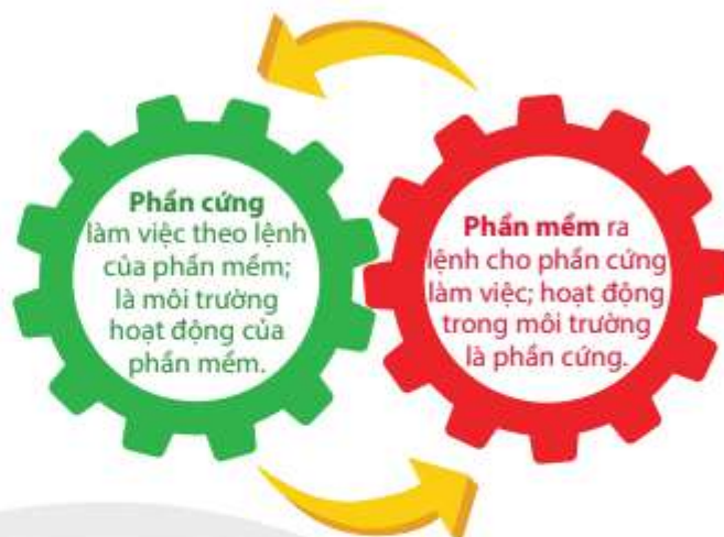
Hình 2. Vai trò, mối quan hệ phụ thuộc giữa phần cứng và phần mềm
