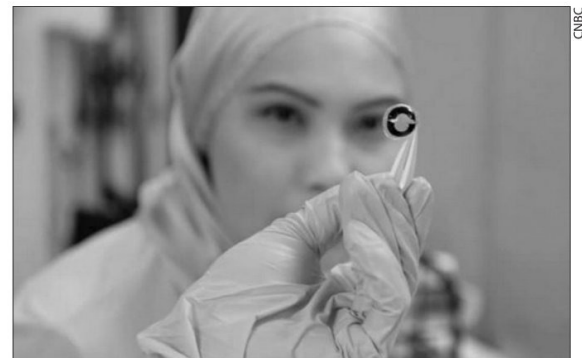
Loại pin dành cho kính áp tròng thông minh chỉ dày 0,2 mm.
