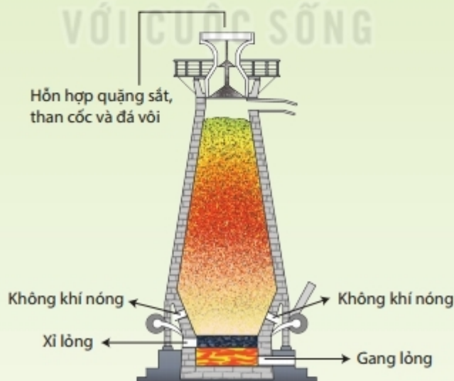
Hình 13.6 Sơ đồ lò cao sản xuất gang
