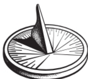
Đồng hồ Mặt Trời đo thời gian dựa vào bóng của vật dưới ánh nắng Mặt Trời
