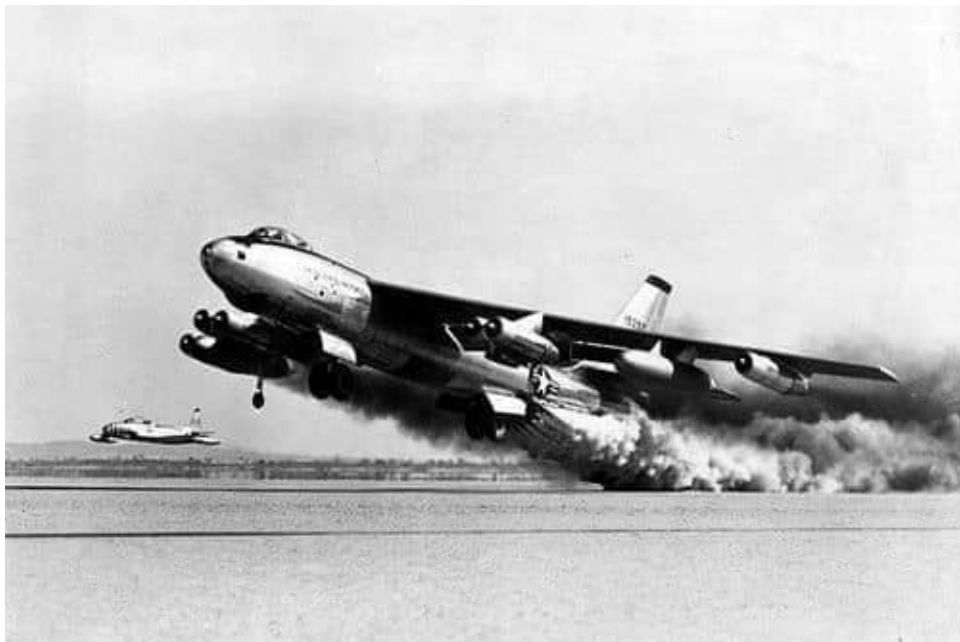
B-47E thử nghiệm hệ thống cất cánh có rocket trợ lực.
