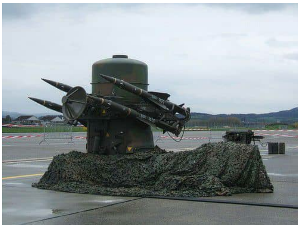
Bệ phóng tổ hợp TLPK Anh “Rapier”. Radar của tổ hợp này có thiết bị hồng ngoại bám sát vật đạn TLPK có điều khiển (“Rapier Darkfire”).
