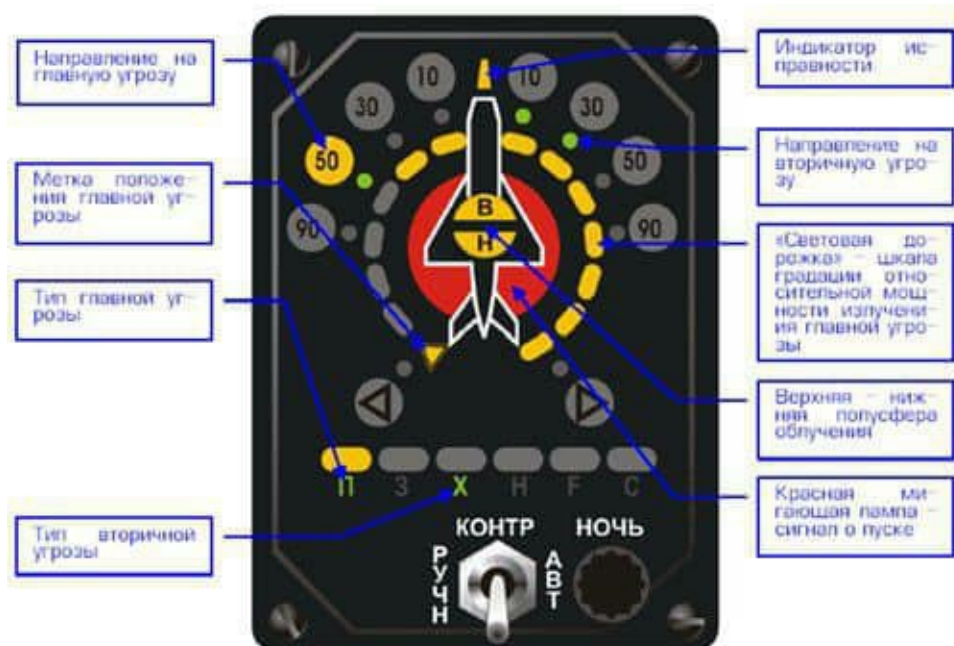
Panel thông tin hệ thống cảnh báo sớm bị chiếu xạ radar SPO-15LM (СПО-15ЛМ) sử dụng trên một số tiêm kích Liên Xô-Nga như Su-27 và MiG-29.
