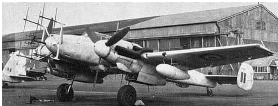
Messerschmitt Me 110G-4 với ăng-ten radar đánh đêm phiên bản đầu FuG 220 + FuG 202 (antenna nhỏ)
