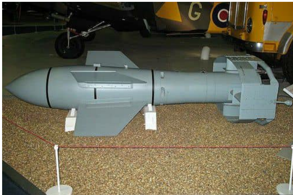
Bom không đối hạm có điều khiển của Đức Quốc xã – Fritz X (Air-to-Ship Wireless Guided Gliding Bomb)
