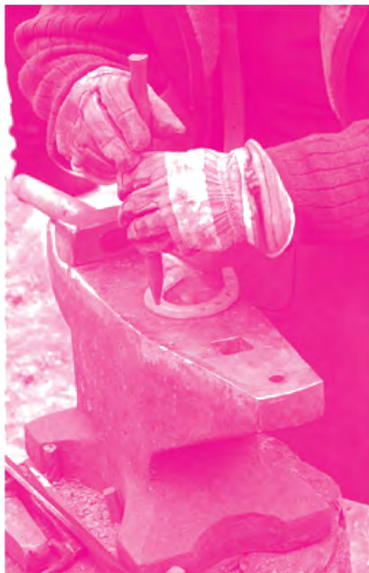
Người thợ rèn đục lỗ để đóng đinh khi chiếc móng ngựa còn đang nóng đỏ.
