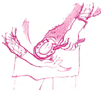
Người thợ rèn đục lỗ để đóng đinh khi chiếc móng ngựa còn đang nóng đỏ.
