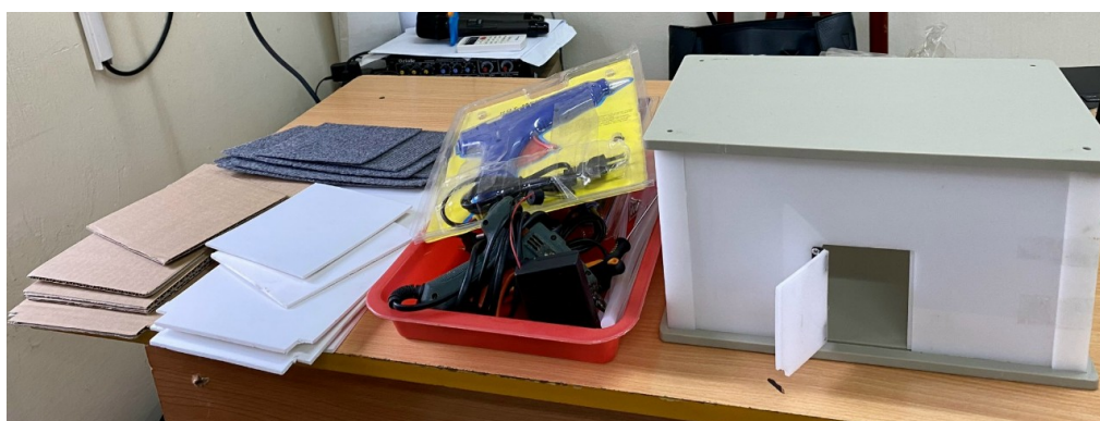
Hình 3.18: Bộ thí nghiệm đánh giá khả năng cách âm của các vật liệu phòng Lab của Công ty Cổ phần Phát hành sách Giáo dục - NXBGDVN
