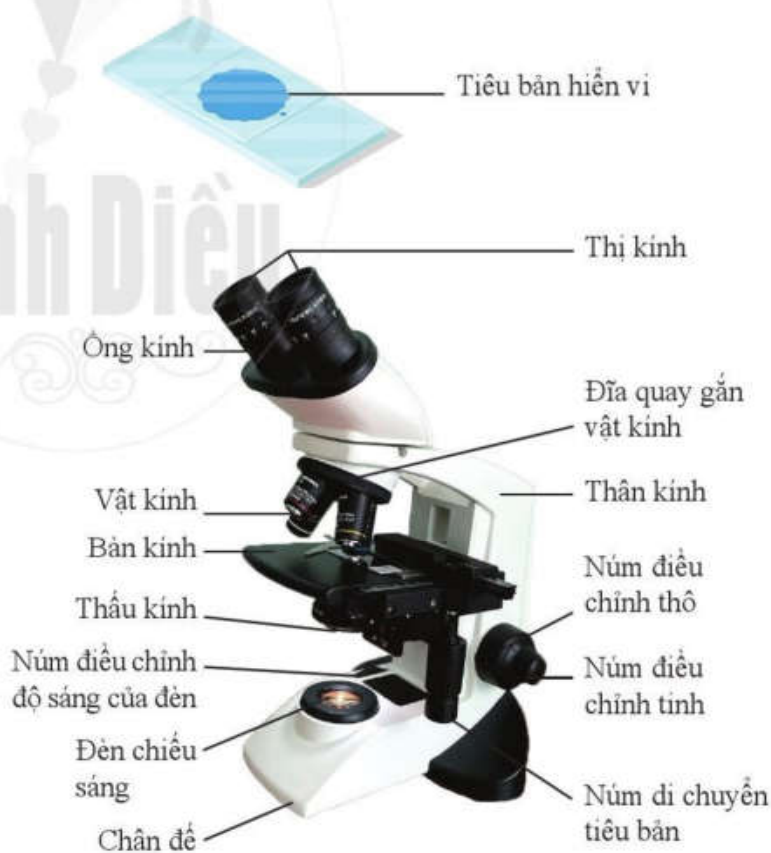
Hình 2.7. Cấu tạo kính hiển vi quang học
