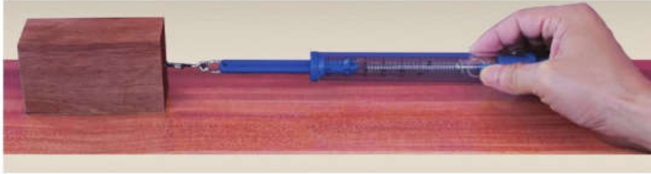
Hình 28.3. Thí nghiệm về lực ma sát
