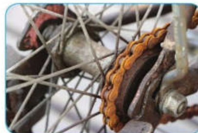
b) Dây xích xe đạp bị gỉ do tiếp xúc với oxygen và hơi nước trong không khí
