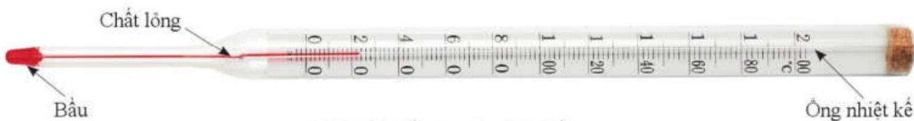
Hình 4.2. Cấu tạo của nhiệt kế
