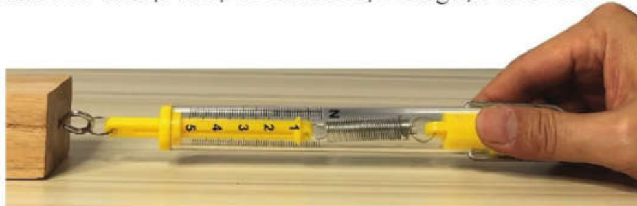
Hình 26.7. Đo lực bằng lực kế lò xo
