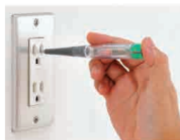
Hình 8.7. Cách sử dụng bút thử điện
