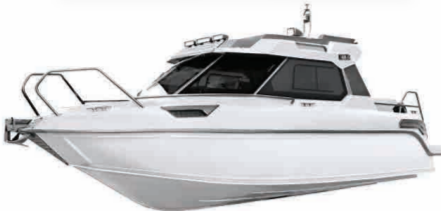
Hình 4.5. Vỏ thuyền làm bằng vật liệu composite
