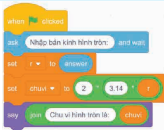
Hình 1. Chương trình tính chu vi hình tròn viết bằng ngôn ngữ Scratch
