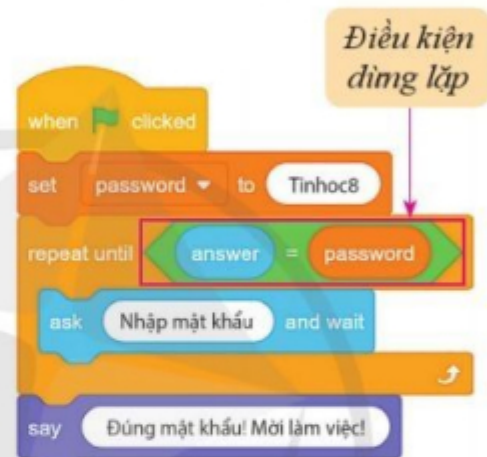
Hình 3b. Một chương trình có cấu trúc lặp với điều kiện dừng lặp
