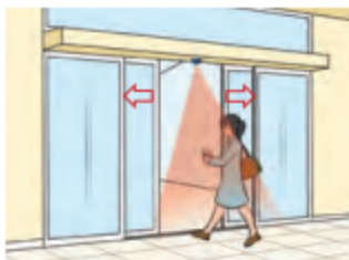
Hình 3. Cửa được gắn cảm biến có thể tự động đóng, mở
