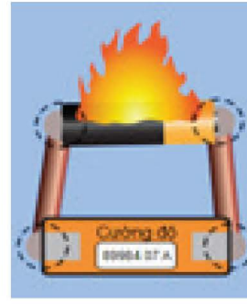
b) Sự cố có thể xảy ra khi lắp Ampe kế không đúng cách
