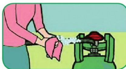
c) Kiểm tra thường xuyên ống dẫn gas bằng nước xà phòng, tuyệt đối không thử bằng lửa
