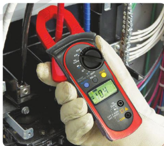
Hình 2.8. Đo cường độ dòng điện bằng ampe kìm
