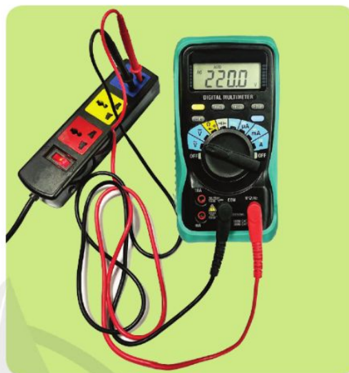
Hình 2.5. Đo điện áp xoay chiều bằng đồng hồ vạn năng
