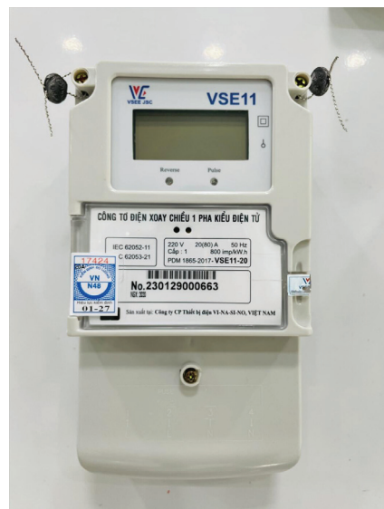
Công tơ điện điện tử
