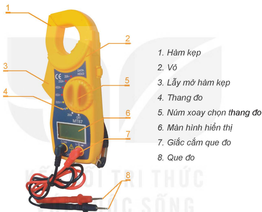
Hình 2.3. Cấu tạo cơ bản của ampe kìm
