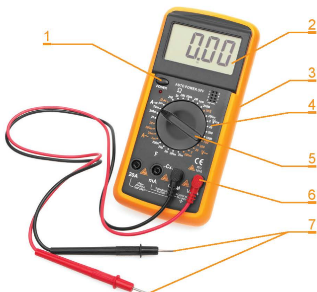
Hình 2.2. Cấu tạo cơ bản của đồng hồ vạn năng
