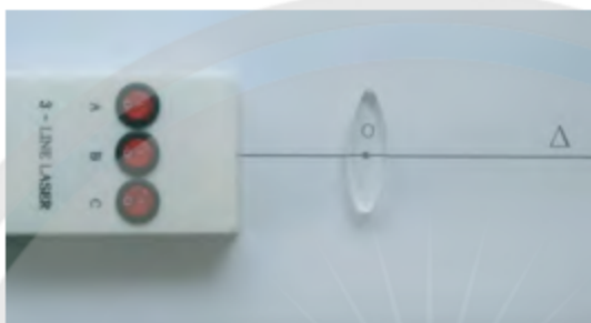
▲ Hình 7.7. Bố trí thí nghiệm khảo sát đường đi của các tia sáng qua thấu kính hội tụ
