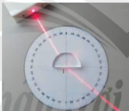
▲ Hình 6.1. Đường đi của tia sáng từ thủy tinh sang không khí dưới góc tới i
