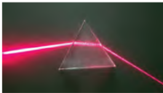
▲ Hình 5.4. Đường đi của chùm tia sáng hẹp màu đỏ qua lăng kính
