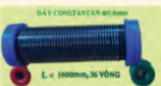
c) Dây constantan dài 1 800 mm, đường kính tiết diện 0,6 mm
