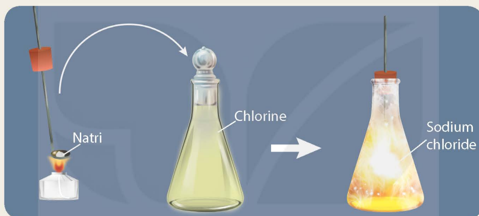
Hình 18.3 Phản ứng của kim loại natri với khí chlorine tạo thành tinh thể muối ăn
