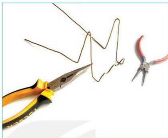
Bước 2. Sử dụng kim để uốn dây đồng tạo dáng sản phẩm
