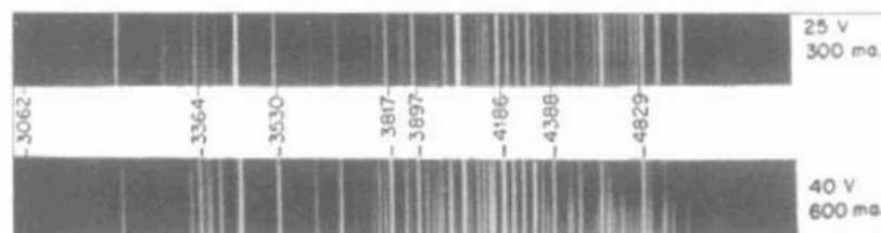
Quang phổ Quang phổ của nguyên tử kali trong những điều kiện kích thích khác nhau: 25 V - 300 ma và 40 V - 600 ma
