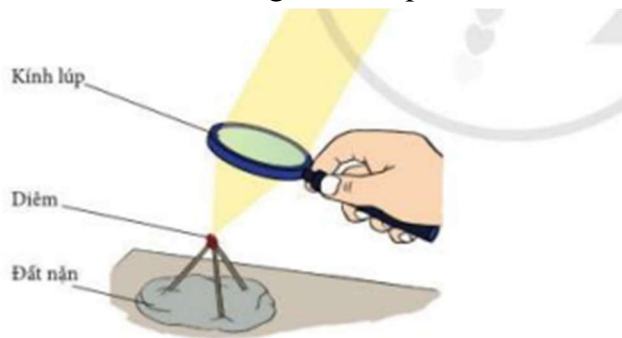
Hình 12.1. Thí nghiệm tập trung ánh sáng mặt trời bằng kính lúp
