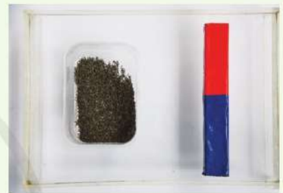
Hình 15.2. Bộ dụng cụ tạo từ phổ
