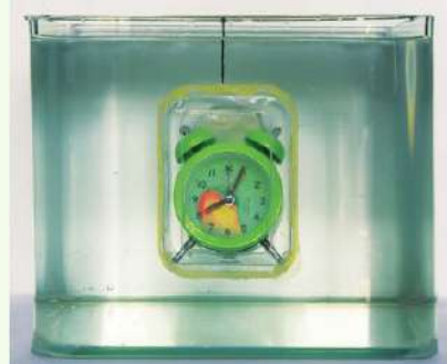
Hình 9.7. Thí nghiệm chứng tỏ âm truyền trong chất lỏng
