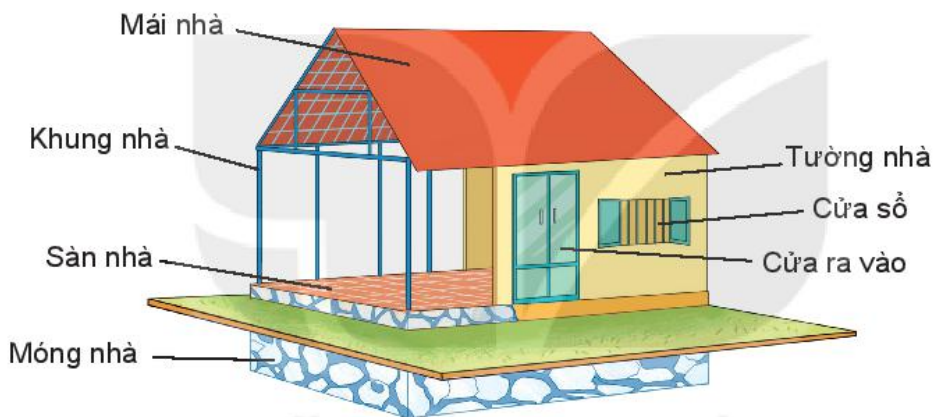
Hình 1.2. Cấu tạo chung của nhà ở
