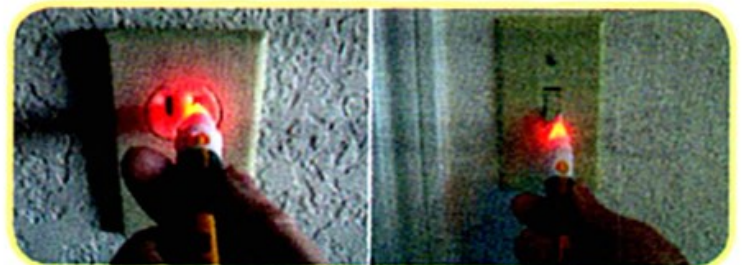
Hình 10.6 Dòng điện có thể làm phát sáng bút thử điện.
