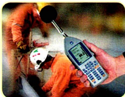
Hình 6.4 Người ta có thể dùng máy đo độ to của âm. Những âm thanh có độ to vượt quá 130 dB sẽ làm đau nhức tai (ngưỡng đau : 130 dB).
