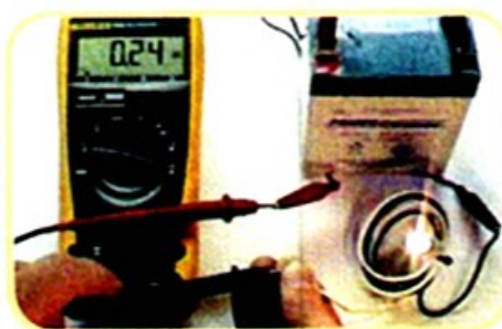
Hình 11.1 Khi bóng đèn càng sáng thì số chỉ của ampe kế càng lớn.
