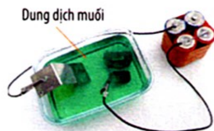
Hình 10.3a Dung dịch muối trong bình điện phân.
