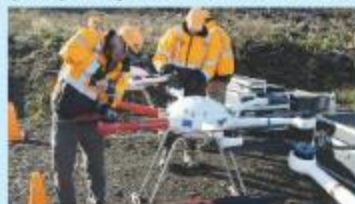
Hình 8.3. Máy bay không người lái được dùng để trồng rừng
