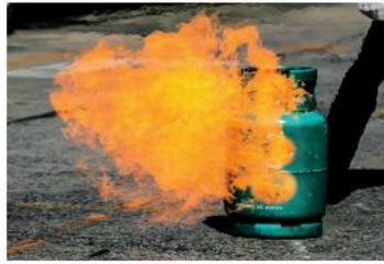
▲ Hình 12.2. Rò rỉ gas gây cháy nổ
