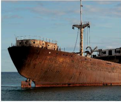
▲ Hình 11.4. Vỏ tàu biển bị ăn mòn
