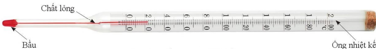
Hình 4.2. Cấu tạo của nhiệt kế
