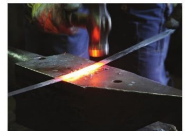
Hình 27.2. Lực tiếp xúc do búa làm biến dạng thanh thép
