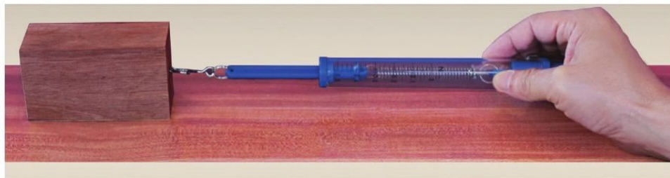
Hình 28.3. Thí nghiệm về lực ma sát
