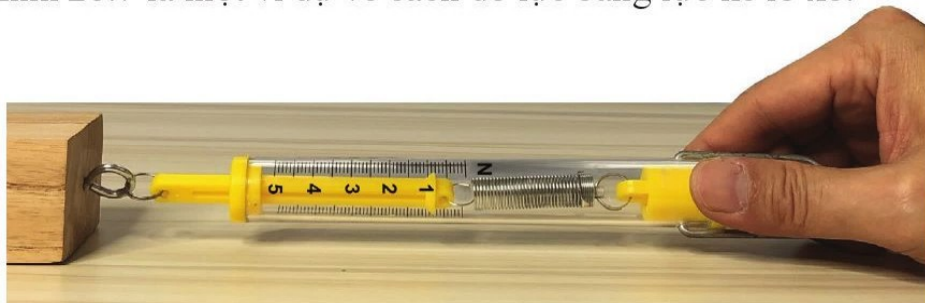
Hình 26.7. Đo lực bằng lực kế lò xo
