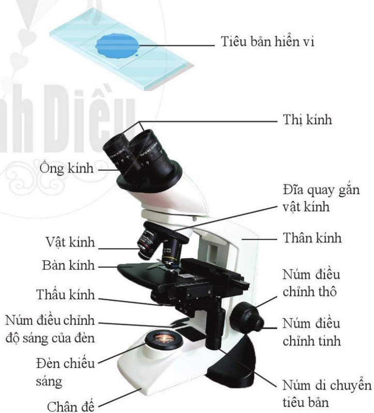
Hình 2.7. Cấu tạo kính hiển vi quang học
