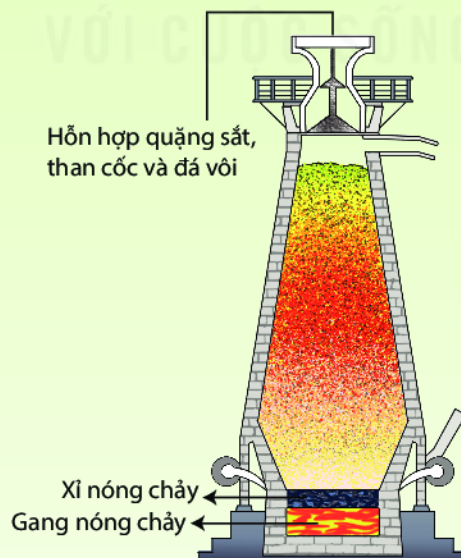
Hình 2.7 Sơ đồ lò cao sản xuất gang
