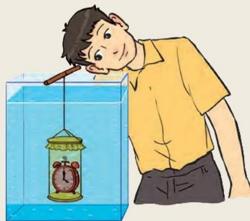
Hình 12.7 Thí nghiệm truyền âm trong môi trường nước
