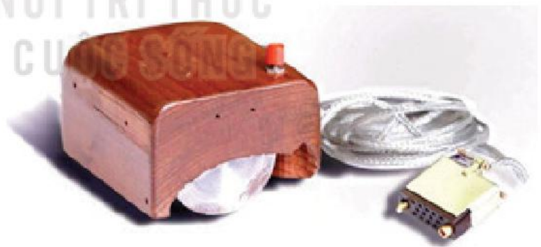
Chuột máy tính đầu tiên bằng gỗ được chế tạo năm 1964
