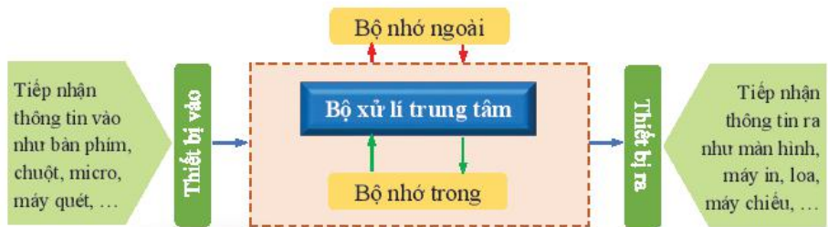
Hình 1. Sơ đồ cấu trúc chung của máy tính
