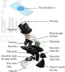
Hình 2.7. Cấu tạo kính hiển vi quang học
