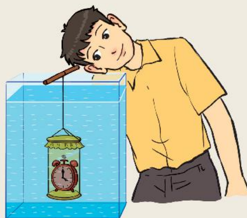
Hình 12.7 Thí nghiệm truyền âm trong môi trường nước
