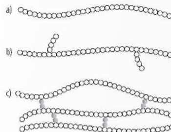
▲ Hình 30.2. Mô hình cấu tạo polymer
