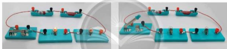
a) b) ▲ Mạch điện gồm hai đèn mắc liên tiếp nhau có công tắc điện: a) đóng, b) mở
