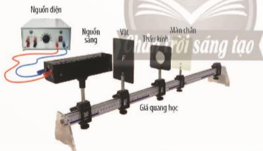
▲ Hình 7.11. Thí nghiệm quan sát ảnh của vật qua thấu kính hội tụ
