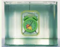
Hình 9.7. Thí nghiệm chứng tỏ âm truyền trong chất lỏng
