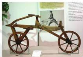
Xe có cấu tạo bằng gỗ và được bọc sắt
