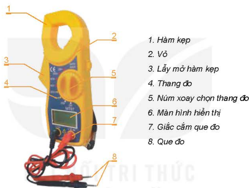
Hình 2.3. Cấu tạo cơ bản của ampe kìm
