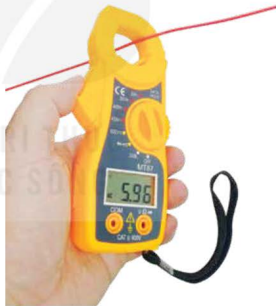
Hình 2.5. Sử dụng ampe kìm để đo cường độ dòng điện
