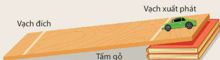
Hình 9.2 Bố trí thí nghiệm đo tốc độ dùng đồng hồ bấm giây
