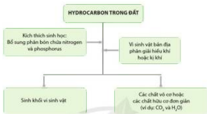
Hình 12.3. Sơ đồ xử lý đất ô nhiễm hydrocarbon bằng phục hồi sinh học
