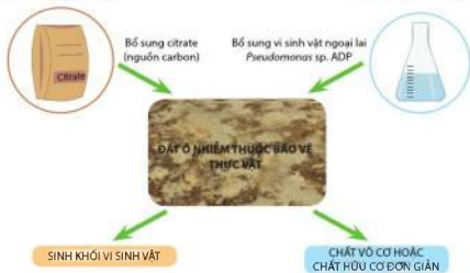
Hình 12.4. Sơ đồ xử lý đất ô nhiễm thuốc bảo vệ thực vật bằng phục hồi sinh học
