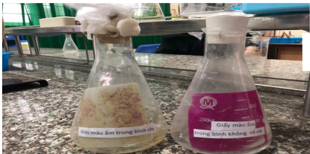
Hình 5. Giấy màu ẩm trước và sau khi cho vào bình khí clo
