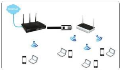
Hình 9.16. Mô hình kết nối Wifi với người dùng
