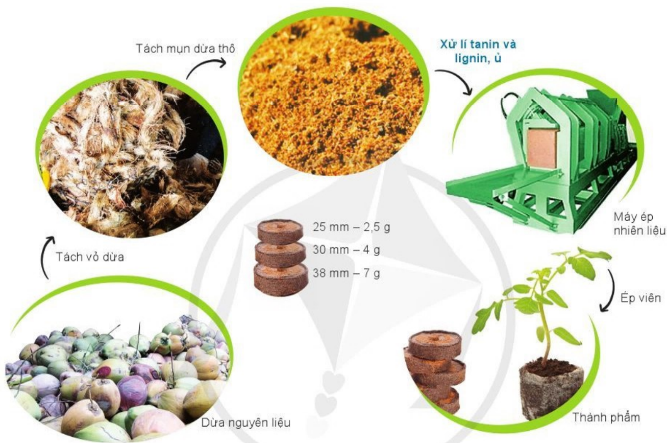
Hình 6.3. Quy trình sản xuất viên nén xơ dừa
