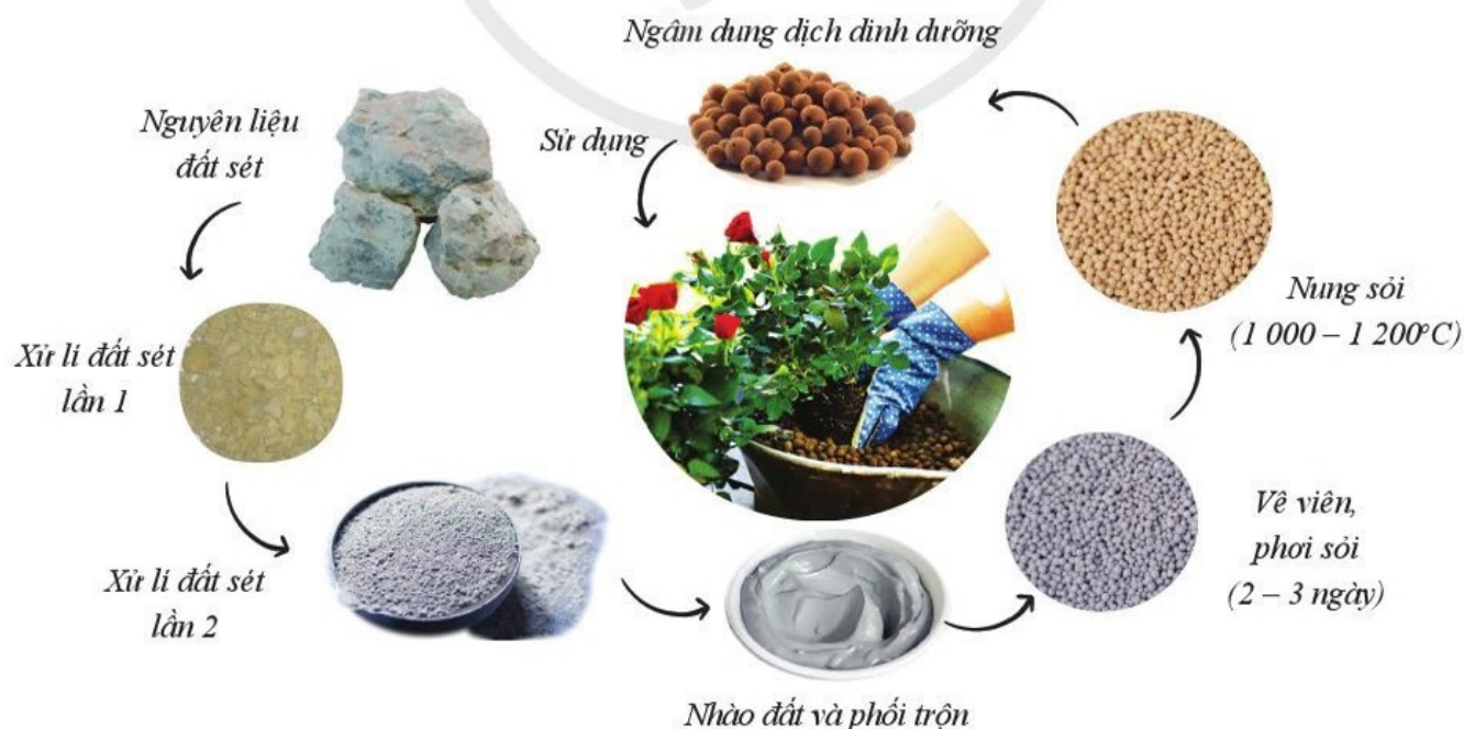
Hình 6.5. Quy trình sản xuất sỏi nhẹ keramzit
