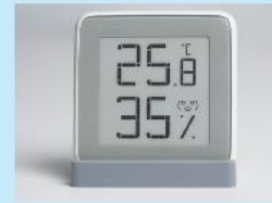
Hình 5.7. Thiết bị đo nhiệt độ và độ ẩm trong nhà
