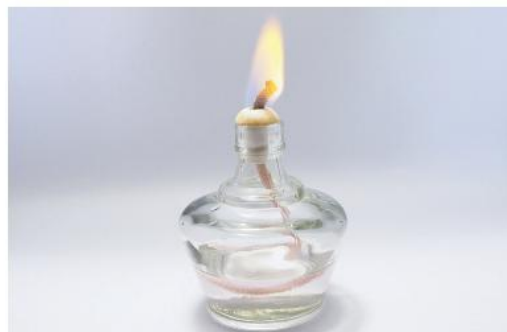
Hình 6.1. Đèn cồn dùng trong phòng thí nghiệm có nhiệt độ ngọn lửa cao.
