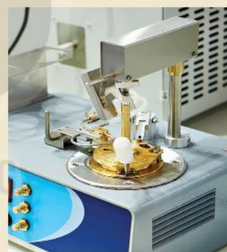
Hình 6.2. Thiết bị cốc hồ Cleveland
