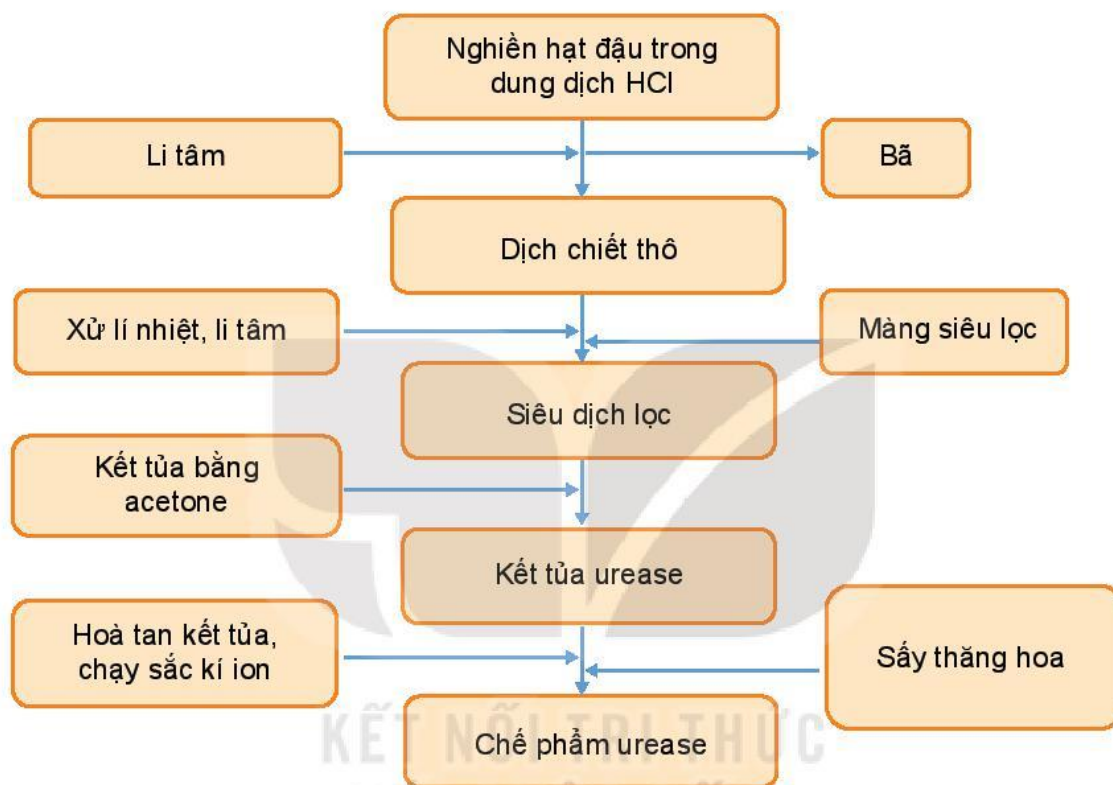
Hình 6.6. Sơ đồ quy trình sản xuất enzyme urease
