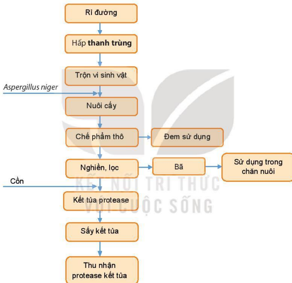
Hình 6.3. Sơ đồ quy trình sản xuất enzyme protease
