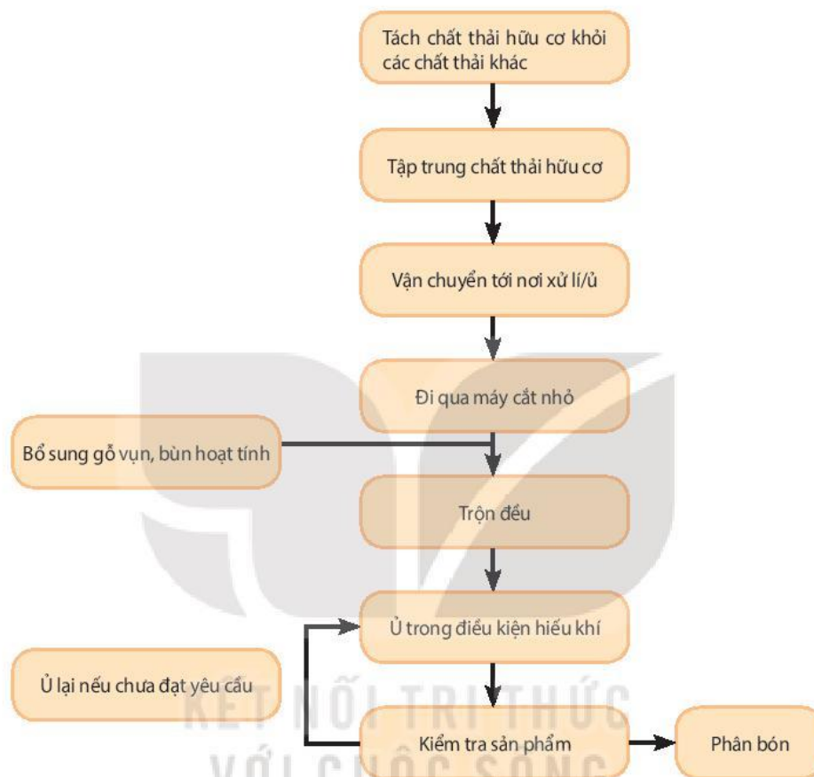
Hình 11.5. Quy trình ủ phân hữu cơ
