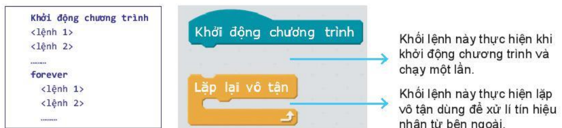
Hình 6.3. Cấu trúc chương trình điều khiển robot
