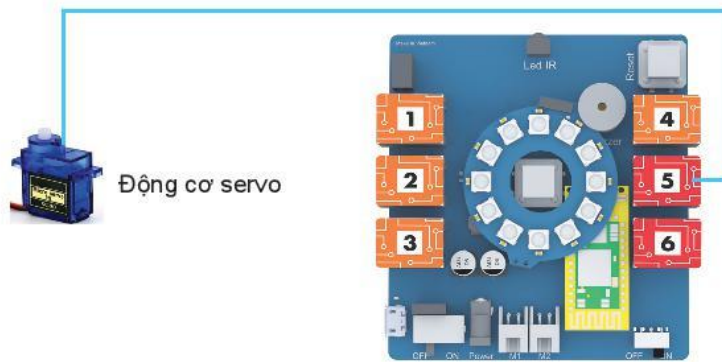
Hình 2.6. Sơ đồ kết nối động cơ servo với robot
