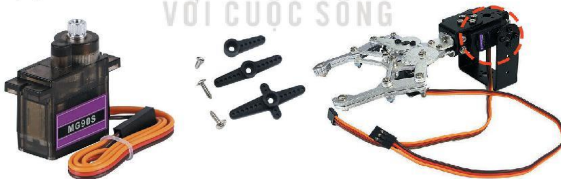
Hình 2.4. Động cơ servo và cánh tay máy gắp đồ vật
