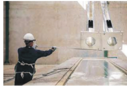
b) Xử lý bề mặt cột điện
